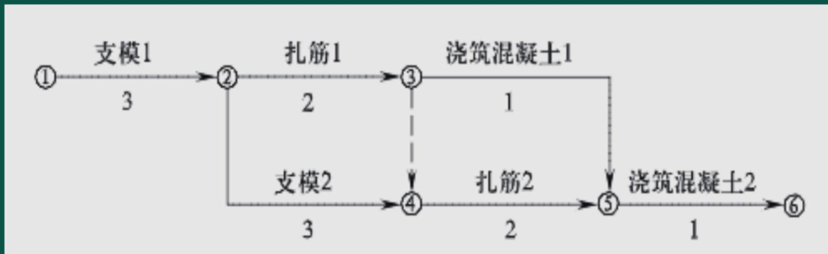
图5-1某混凝土工程双代号网络计划
