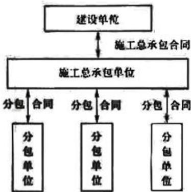
图 6-1 施工总承包合同结构
