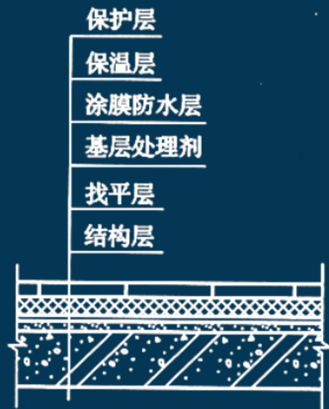
图 11-17 倒置式屋面
