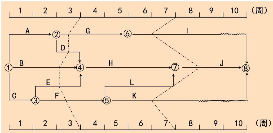
【多选题】某工程时标网络计划如下图所示，当工程进行到7月底时，检查了该工程实际进度前锋线，根据7月底检查该工程的实际进度结果表明（ ）。
